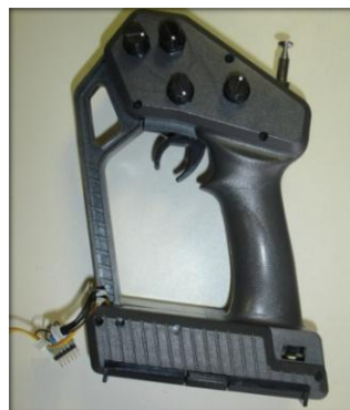
Figura 66. Adição de novos potenciômetros no telecomando.
