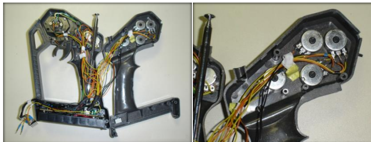
Figura 65. Aquisição do sinal dos potenciômetros no telecomando.
