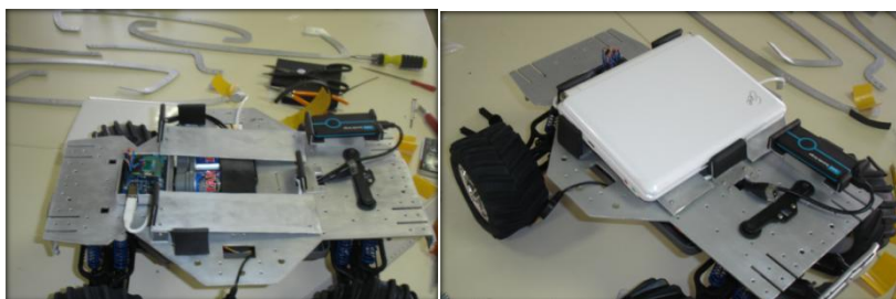
Figura 86. Montagem de suportes para a Banda Larga móvel.
