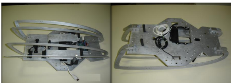
Figura 87. Vigas de protecção, vista da parte superior e da parte inferior.
