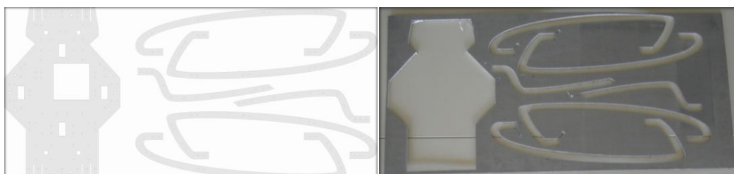
Figura 80. Protótipo desenhado no Corel Draw e o resultado final após o processamento da chapa pela máquina CNC.
