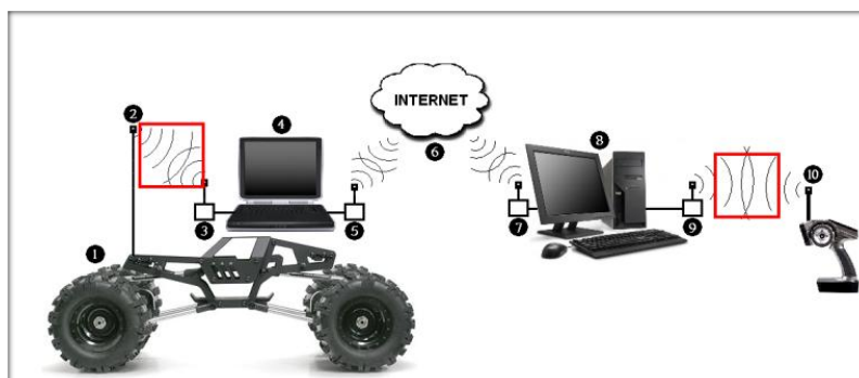
Figura 23. Ligação sem fios entre o micro controlador e os dispositivos eléctricos
