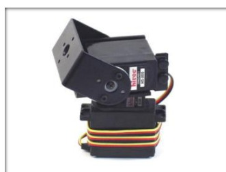
Figura 17. Dois servo motores implementando o sistema Pan/Tilt.
