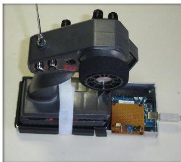
Figura 61. Ligação sem fios entre o comando e o micro controlador
