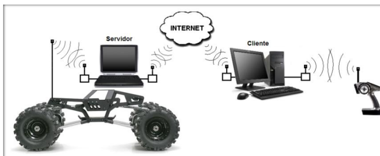
Figura 20. Arquitectura do modelo cliente servidor para o projecto.
