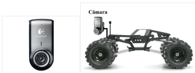
Figura 12: Uma webcam da Logitech para notebooks, à direita, e o esquema com a câmara alojada no veículo, à esquerda.
