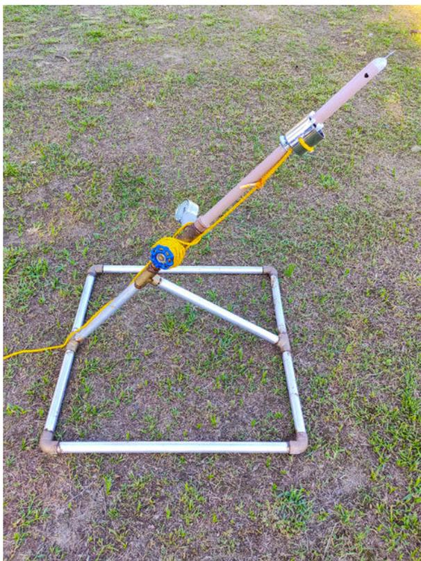
Como você pode ver, há um prego na ponta do cano de PVC na qual a garrafa será colocada, esse prego serve para estourar o balão de vinagre que será colocado dentro do foguete e, assim, iniciar a reação dentro do foguete que o fará voar, mas falaremos sobre a reação química apenas na etapa 4, Há também um buraco neste cano PVC para que a pressão interna do foguete seja medida pelo manômetro na hora do lançamento.
