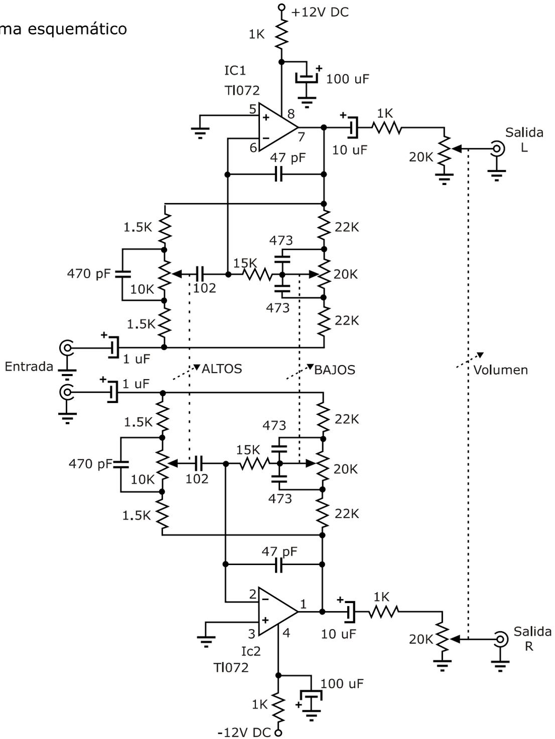
**NOTA:** Los condensadores de 0.047 (473) se pueden reemplazar por 0.015 (153) y de esa manera cambiar la respuesta de bajos. Use los que mas le gusten.
